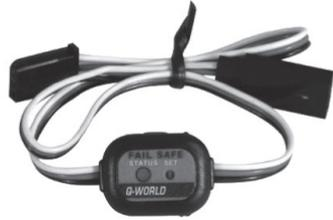
Bekannt ist auch die Fail-Save-Elektronik bei Modelleisenbahnen. Sollten die Bahnen keine definierbaren Steuersignale mehr senden, aktiviert diese Elektronik das »Fail Save« und eine vorher eingestellte Steuerfunktion wird aktiviert.
